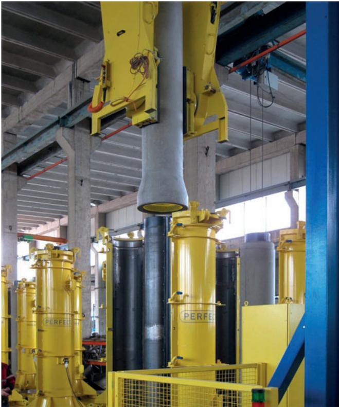
На фоне растущей популярности пластиковых труб, замоноличиваемых в бетон или укладываемых в подвижный грунт, труба Perfect Pipe с надежной противокоррозионной облицовкой из полиэтилена высокой плотности возвращает бетон в игру
